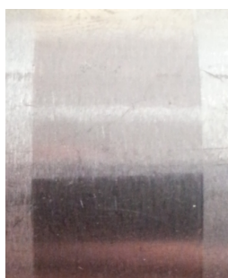
Рис. 5. Рельеф поверхности при обработке по тангенциальной схеме
