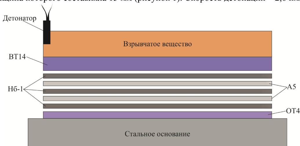
Рис. 1. Схема сварки взрывом многослойного композита Nb и Al
