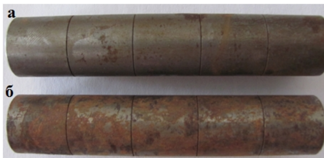
Рис. 3. Состояние поверхности образцов а и б после 30 часов испытаний: а - эпиламированный; б - неэпиламированный.
