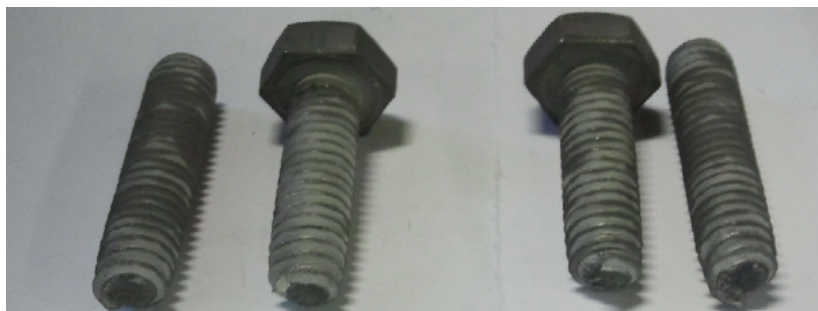
Рис. 1. Образцы крепежных элементов с диффузионным цинковым слоем после испытания
